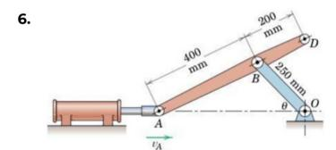
El cilindro hidraulico de la figura, produce un movimiento horizontal limitado del punto A. Si se conoce que  $v_A$  = 2 m/s cuando  $\theta=45^o$ , determinar el valor de la velocidad angular de la barra ABD, en rad/s
