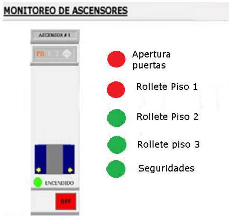
Imagen 10.- Monitoreo del ascensor
