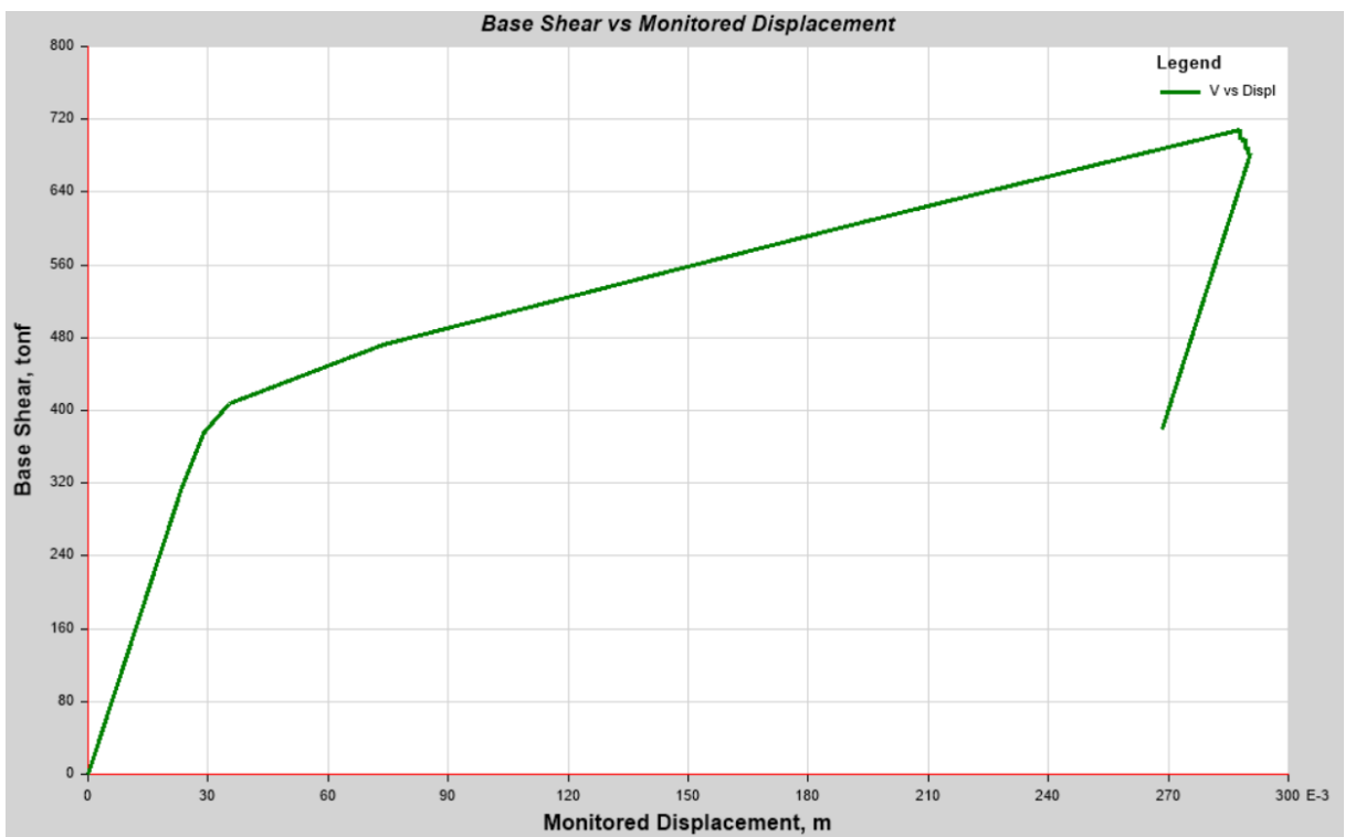
Ilustración. Curva de capacidad “Pushover” C2. Eje Y (Autores)
