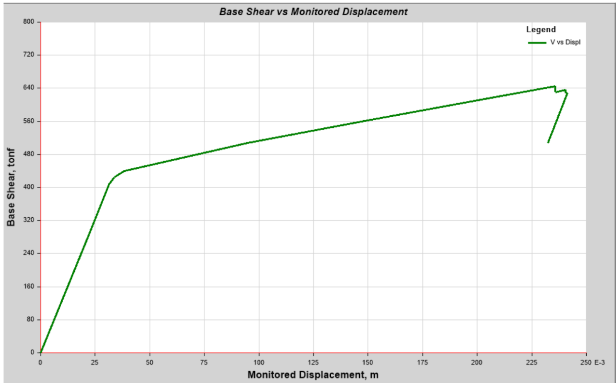
Ilustración. Curva de capacidad “Pushover” ET. Eje X (Autores)
