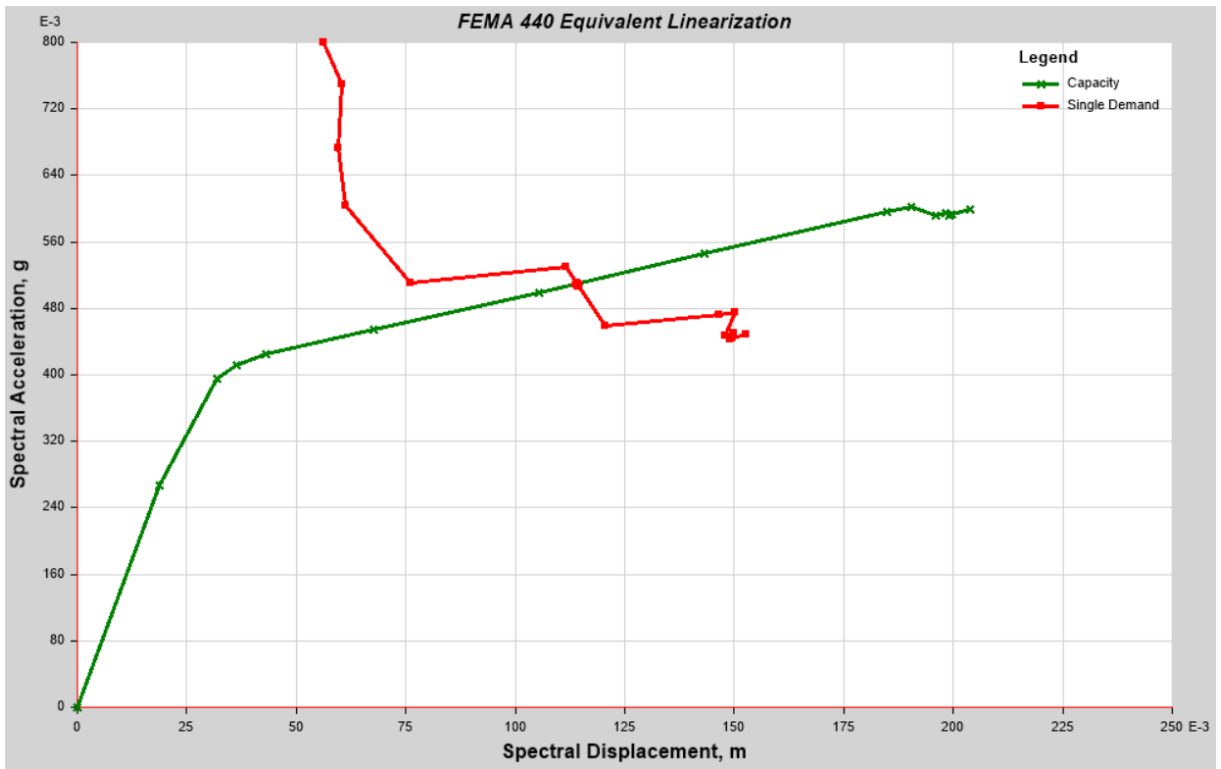
Ilustración. Curva FEMA 440 Equivalent Linearization C3. Eje X (Autores)
