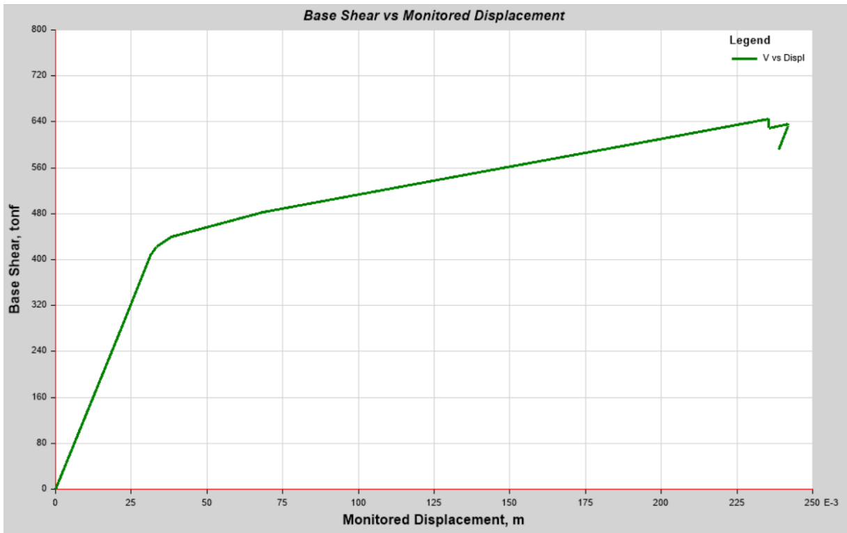
Ilustración. Curva de capacidad “Pushover” C1. Eje X (Autores)
