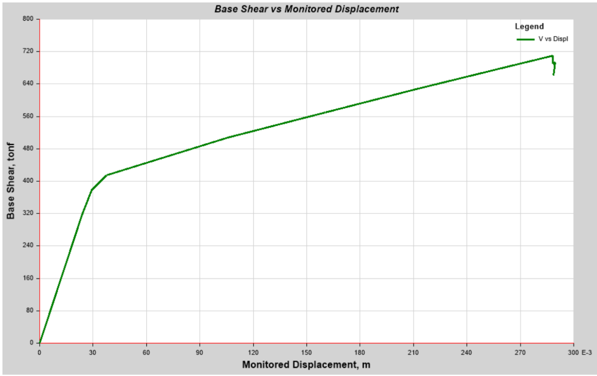
Ilustración. Curva de capacidad "Pushover" C3. Eje Y (Autores)
