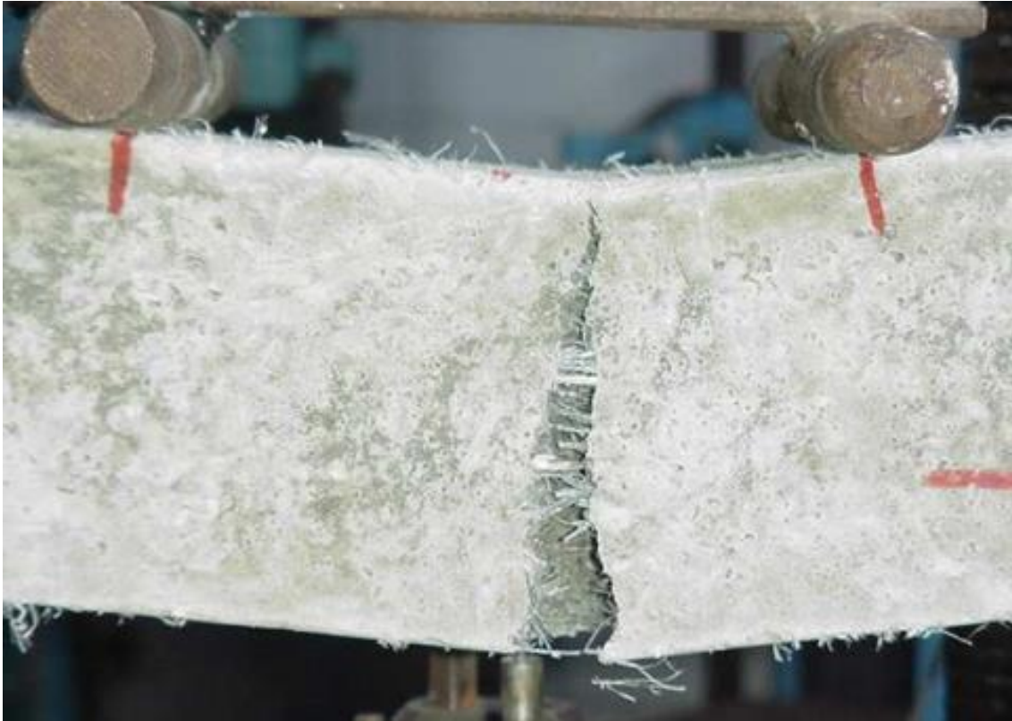
Ilustración 4.9. Ensayo a flexión de probeta de hormigón reforzada con fibras de Sisal, (Centeno et al., 2012)
