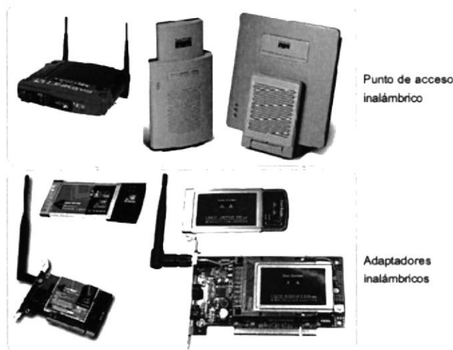
Fig2.13: Adaptadores y puntos de acceso de una red inalámbrica. Fuente: www.cisco.com
