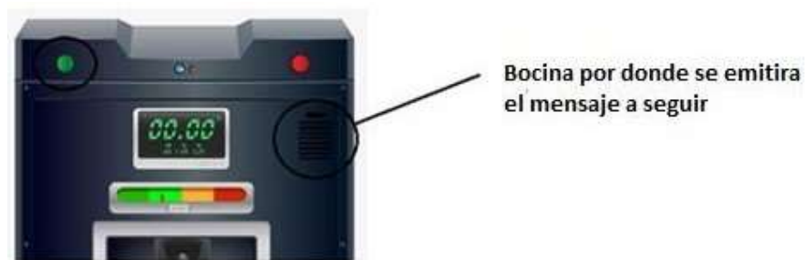
Figura A5.4 Parte frontal de la solución final donde se muestra la ubicación de la bocina
