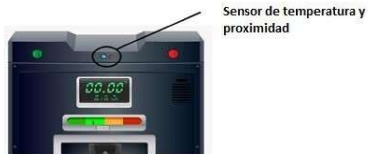
Figura A5.1 Ubicación de los sensores de temperatura y proximidad
