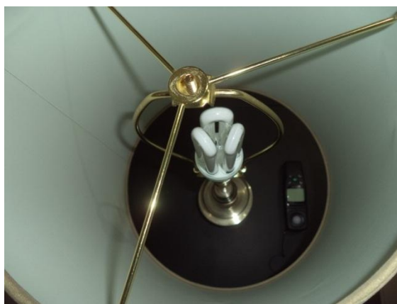
Figura 1.15: Configuración para medición de Luminaria Bajo Prueba con Luxómetro
