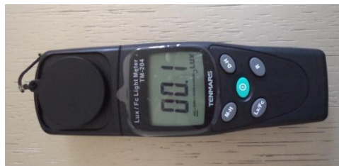
Figura 1.13: Luxómetro marca TENMARS Modelo TM-204
