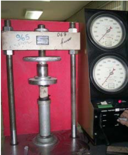
Prueba de Compresión Simple, Cilindro A y Cilindro C
