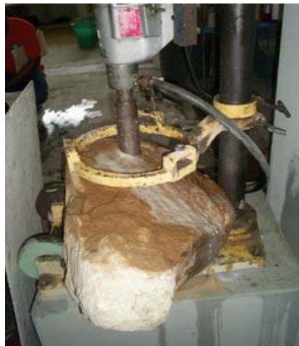
Detalle de la Extracción de la Muestra Inalterada
