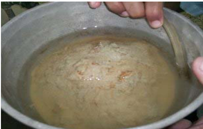
Ensayos de Saturación, Lutita 20 minutos sumergida
