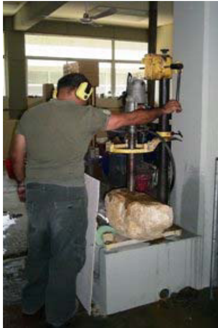
Extracción de la muestra inalterada
