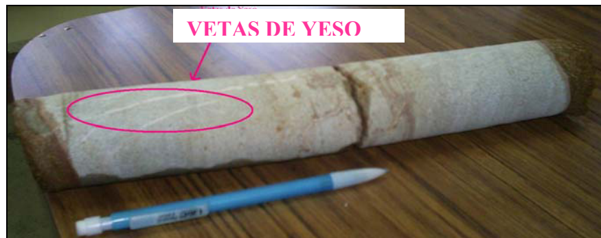
Figura 2.5.2 Imagen de un testigo extraído, nótese las vetas de yeso. Muestra inalterada
