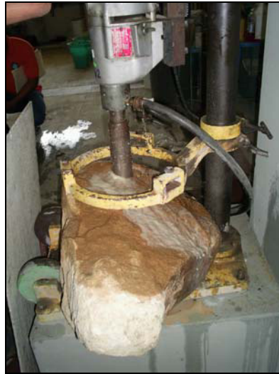
Figura 2.5.1 Extracción de testigos de Muestra No.5 para la Prueba de Compresión Simple.
