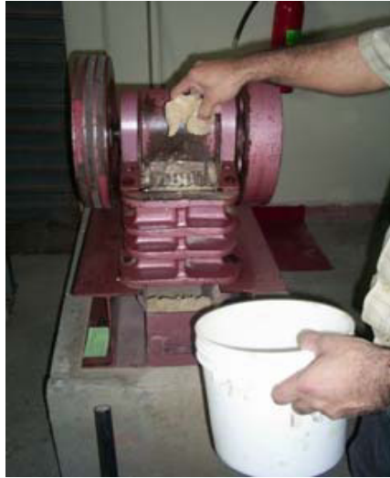
Molienda del Material, Trituradora de Mandíbulas
