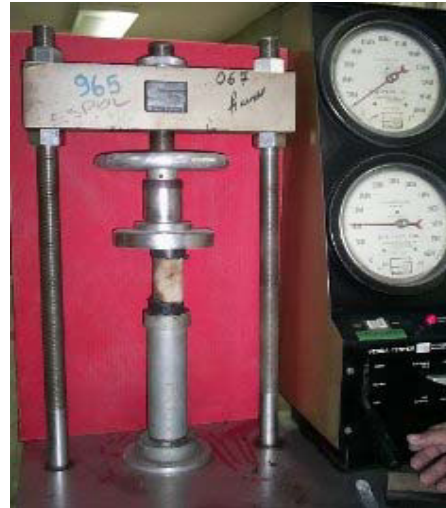
Prueba de Compresión Simple, Cilindro A y Cilindro C
