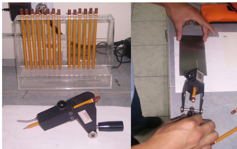
FIGURA 3.31. PRUEBA DE DUREZA AL LÁPIZ INEN 1001.
