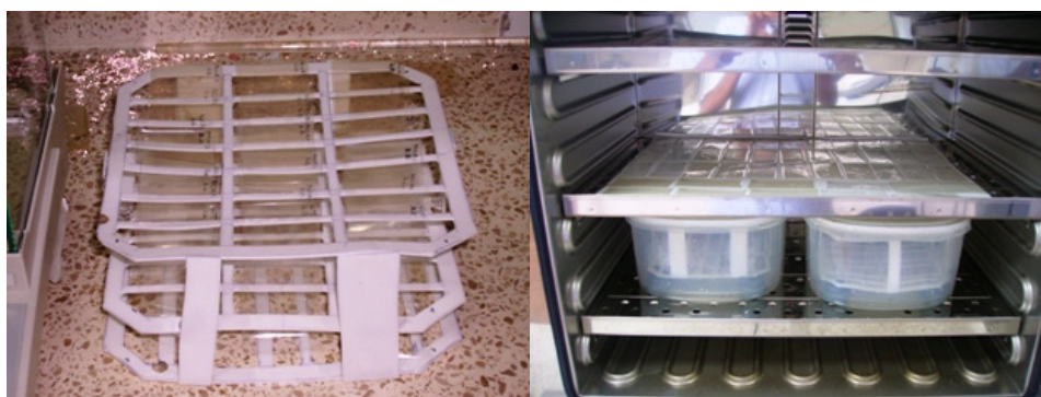
FIGURA 3.29. PROBETAS EN ESTRUCTURA DE PLÁSTICO Y RECIPIENTES EN ESTUFA
