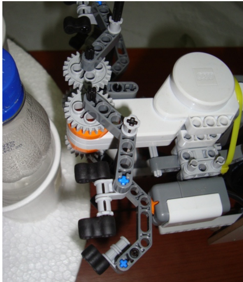
Fig. 3.6: Sensor de tacto para limitar la apertura de la tenaza.
