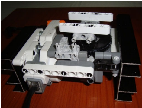
Figura 2. Motor A, utilizado para mover la bandeja giratoria.
