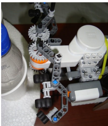
Figura 6. Sensor de tacto para limitar la apertura de la tenaza.
