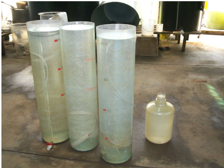
Desinfección de cilindros y carboy: cloro y agua dulce
