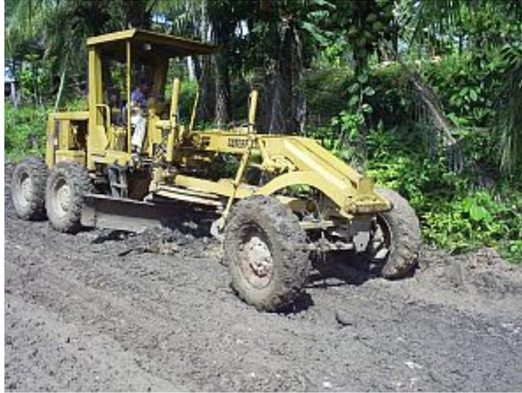
Nivelación del material estoqueado por motoniveladora
