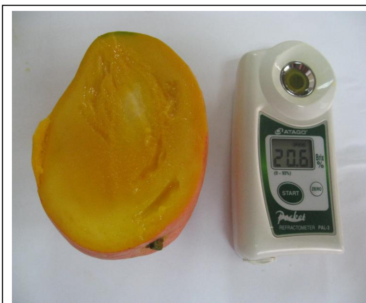
°Bx del mango tomados con refractómetro digital
