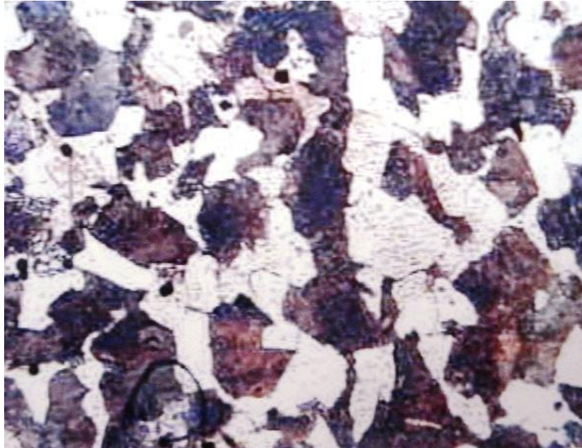
FIGURA 2.10 MICROESTRUCTURA 8 MATERIAL DEL EJE PRINCIPAL DE MANDO ACOPLADO AL TORNILLO HELICOIDAL COMPUESTA POR FERRITA Y PERLITA
