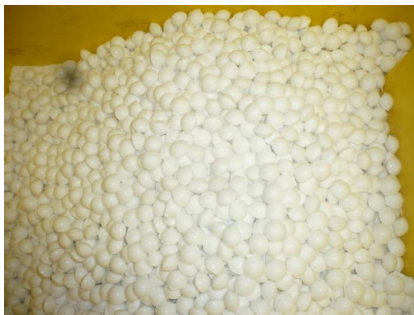
FIGURA # 1.4 BRIQUETAS DE UREA
