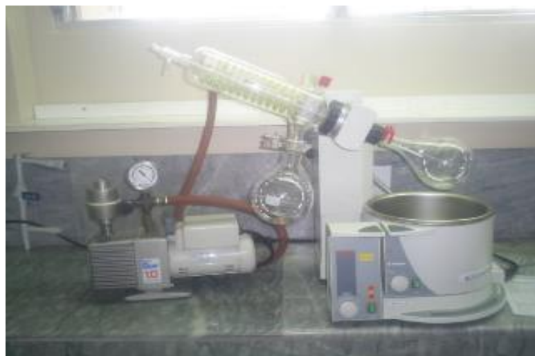
FIGURA 2.1. ROTAVAPORADOR LABOROTA 4001 HEIDOLPH Y BOMBA DE VACIO WELCH 1.0 VACUUM PUMP
