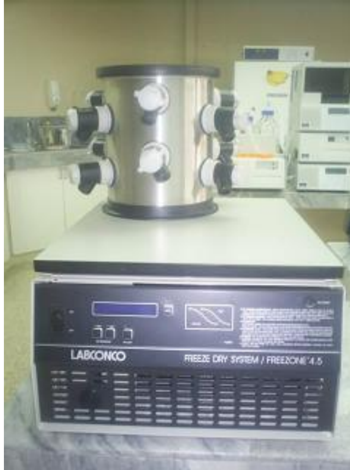
FIGURA 2.2. LIOFILIZADOR LABCONCO FREEZE DRY SYSTEM / FREEZONE 4.5
