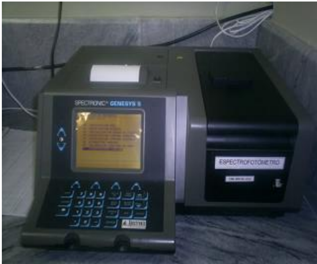
FIGURA 2.4. ESPECTROFOTOMETRO SPECTRONIC GENESYS 5
