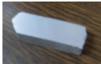
FIGURA 2.3.B) PROBETA PARA ENSAYO DE DUREZA
