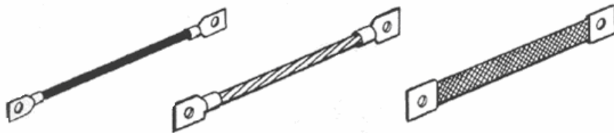
FIGURA 7. Cables puentes de unión.
