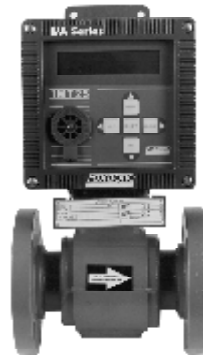
Figura 2.10.- Sensor de flujo másico con transmisor integrado.
