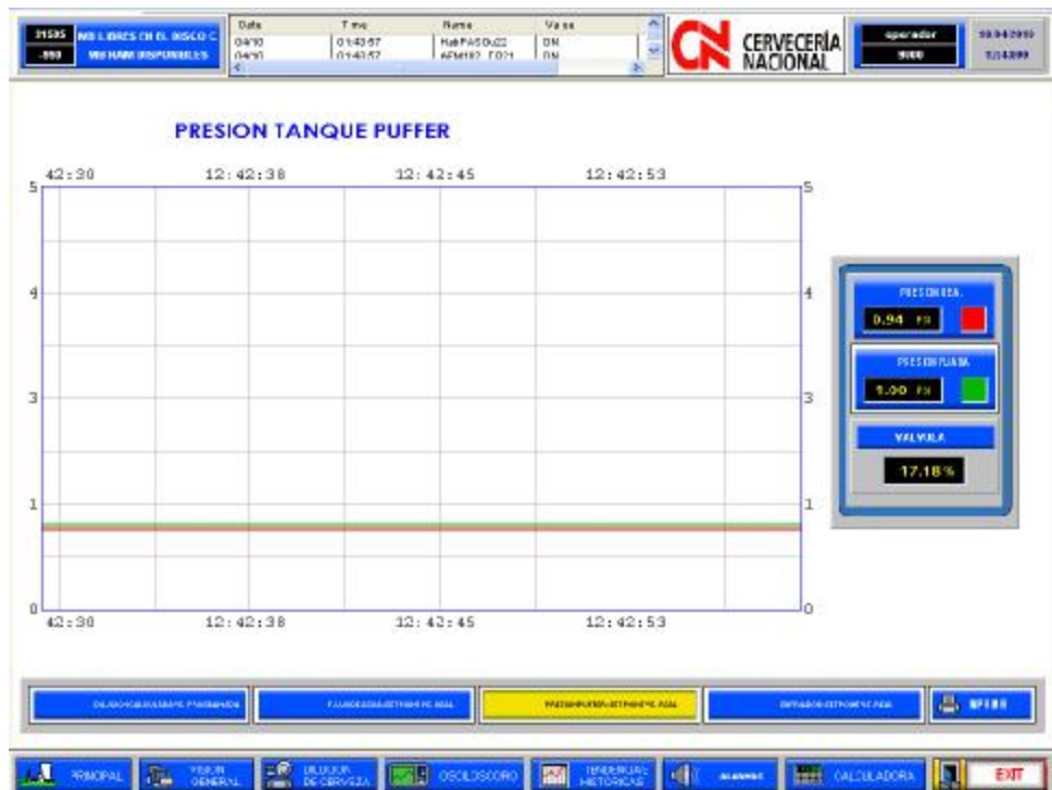
Figura 5.48.- Curvas Presión fijada Vs Dilución Real, con un PID ya sintonizado.
