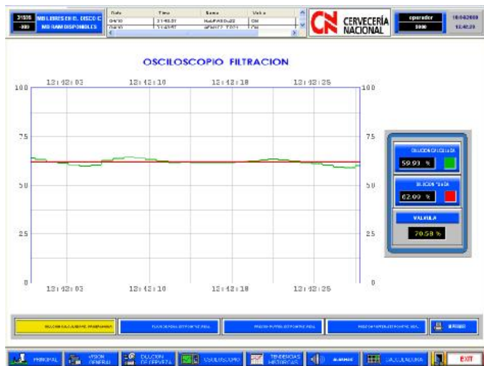
Figura 5.47.- Curvas Dilución fijada Vs Dilución Calculada, con un PID ya sintonizado.
