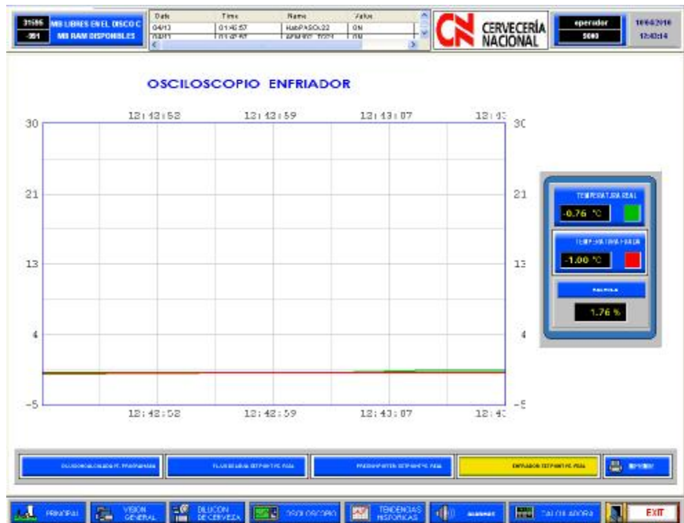
Figura 5.49.- Curvas Temperatura fijada Vs Temperatura Real, con un PID ya sintonizado.
