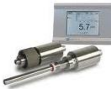
Figura 2.17.- Sensor de O2 en línea y su transmisor remoto con display de pantalla táctil.
