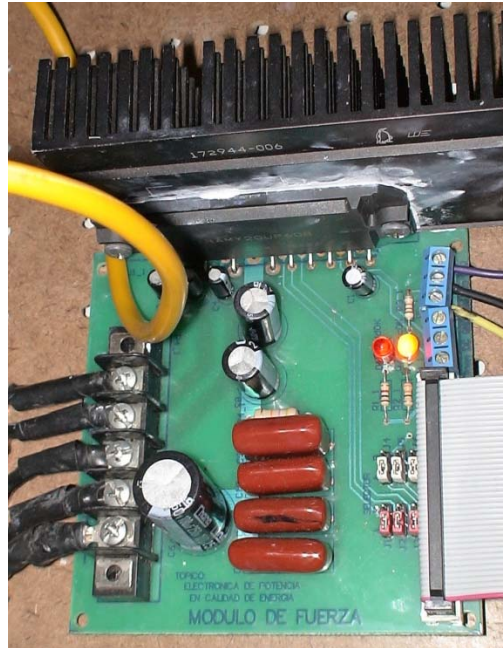
Fig. 3.42 Foto del módulo de fuerza.
