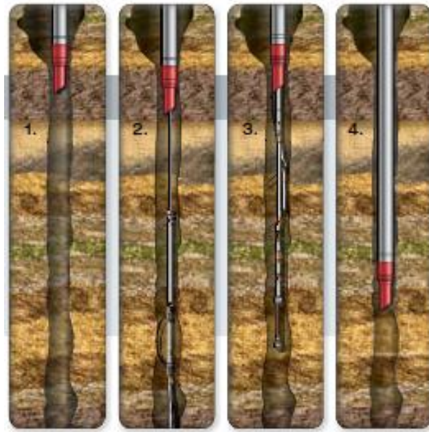
FIGURA 3.4 REGISTRO A TRAVES DE TUBERIA.
