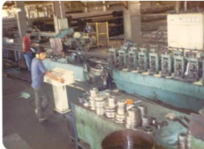
Fig. # 4.- Máquina de formado en frío por rodillos
