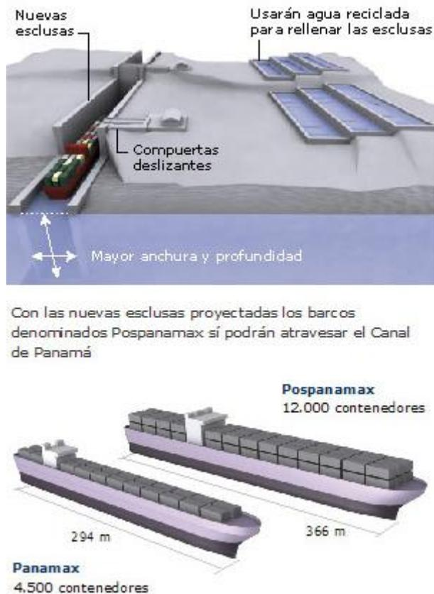
**FIGURA 2.11** PROYECTO DE AMPLIACIÓN DEL CANAL DE PANAMÁ [7]
