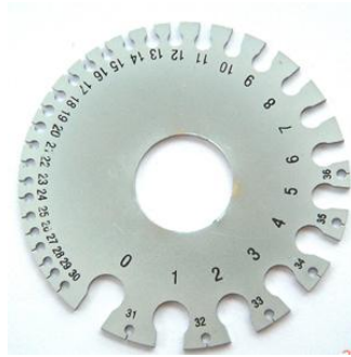
Figura 38. Calibrador de conductores eléctricos. Mientras mayor es el número, menor es el diámetro del conductor eléctrico.
