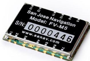
Figura 4 Módulo GPS FV-M5 marca SANAV [6]
