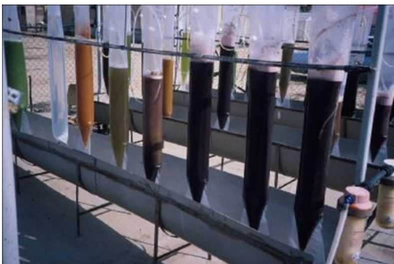
Figura 10: Reactores verticales elaborados con fundas.
