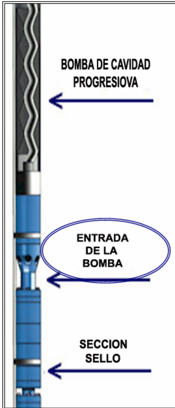
Fig. 2.13.- Entrada de la Bomba o Intake
