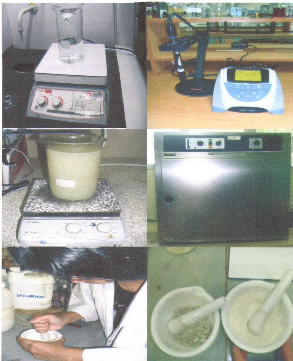
FIGURA 3.9. MEZCLA DE LA SOLUCIÓN HCl AL 0.01N CON SURFACTANTE AMINO ALCOHOL, MEDICIÓN DE Ph, ADICIÓN DE CLOISITE Na, SECADO DE LA MUESTRA Y MOLIENDA.
