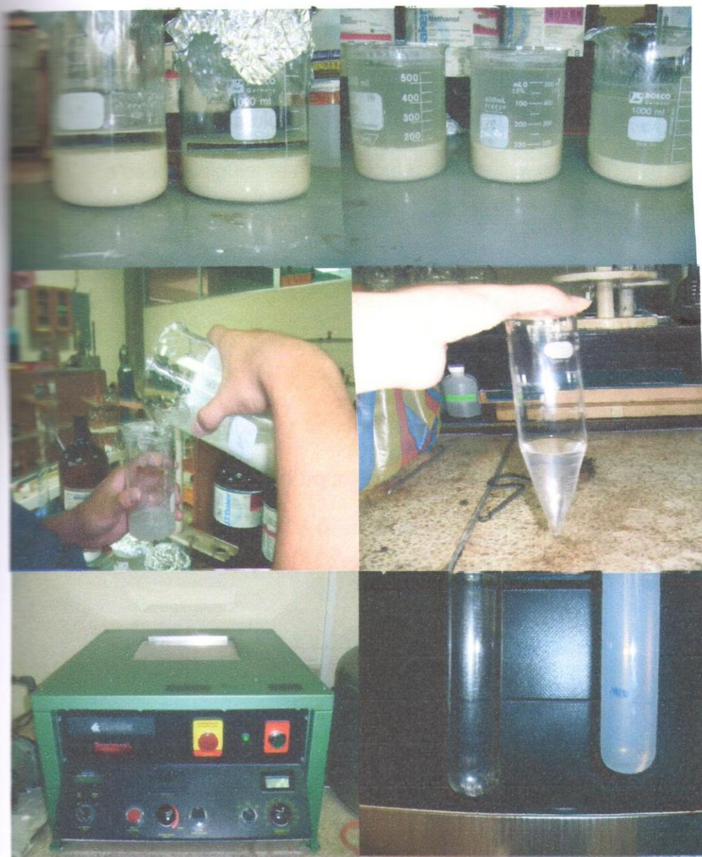
FIGURA 3.5. PROCEDIMIENTO DE LAVADO DE LAS NANOARCILLAS: DECANTACIÓN, CENTRIFUGACIÓN, ANÁLISIS CON NITRATO DE PLATA. SE OBSERVA LA PRESENCIA DE CLORUROS.
