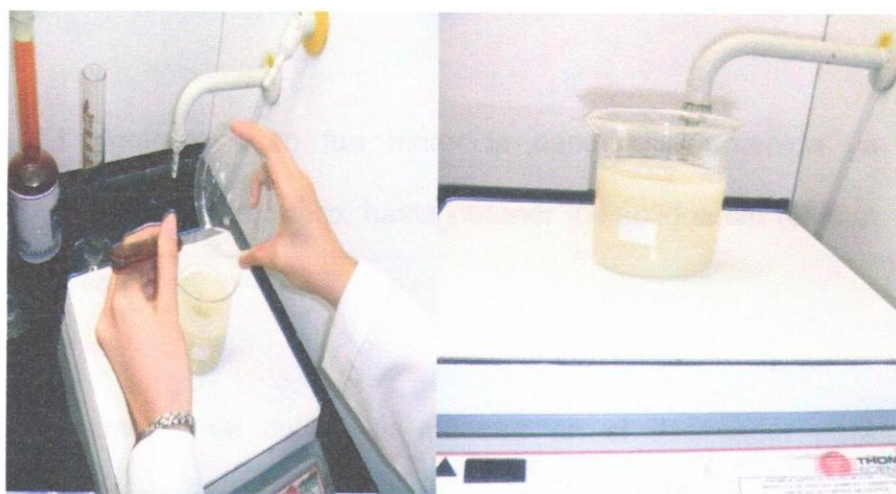
FIGURA 3.8. ADICIÓN DE SURFACTANTE A LA MUESTRA Y USO DE AGITADOR MAGNÉTICO DE 3-4 HORAS.
