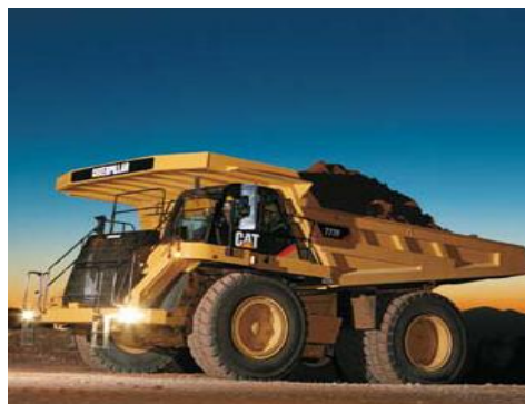
Figura 59. Volqueta para movimiento de tierra
