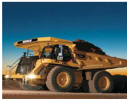
Figura 59. Volqueta para movimiento de tierra.
