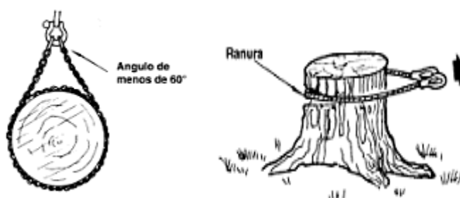
Figura 33. Arranque de tocones mediante cadenas (FUENTE: Libro: Métodos sencillos para la acuicultura: Construcción de estanques).
