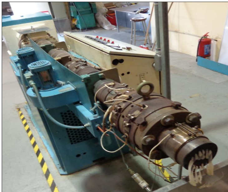
FIGURA 3. 14 EXTRUSORA DE TORNILLO SIMPLE MODIFICADA.
