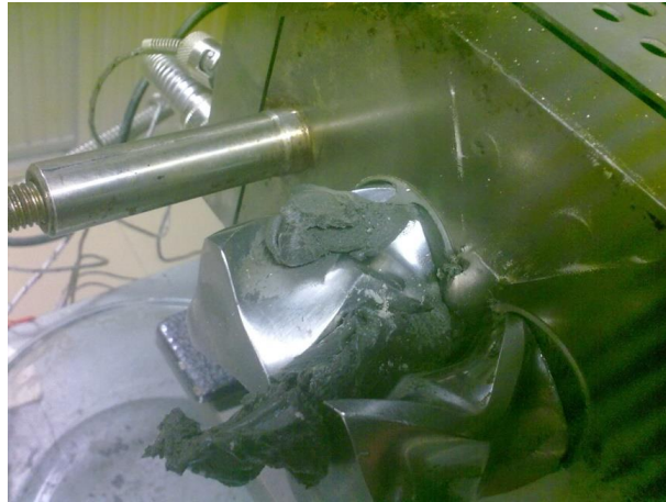
FIGURA 3.23. 85% HDPE MEZCLADO CON 15% DE ZEOLITA.
