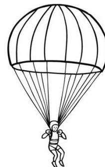
Cuando el paracaidista en caída libre abre el paracaídas, además de su peso, actúa sobre él una fuerza de rozamiento con el aire, lo cual produce que su velocidad cambie hasta alcanzar una velocidad límite constante  $v_l$ , que es independiente de la velocidad inicial del paracaidista en el momento de abrir el paracaídas.
