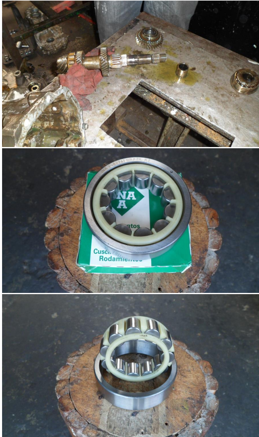
FIGURA 3.42 RODAMIENTO DELANTERO Y PISTA EXTERNA DEL RODAMIENTO (ÁRBOL DEL PIÑÓN – EJE SECUNDARIO)
