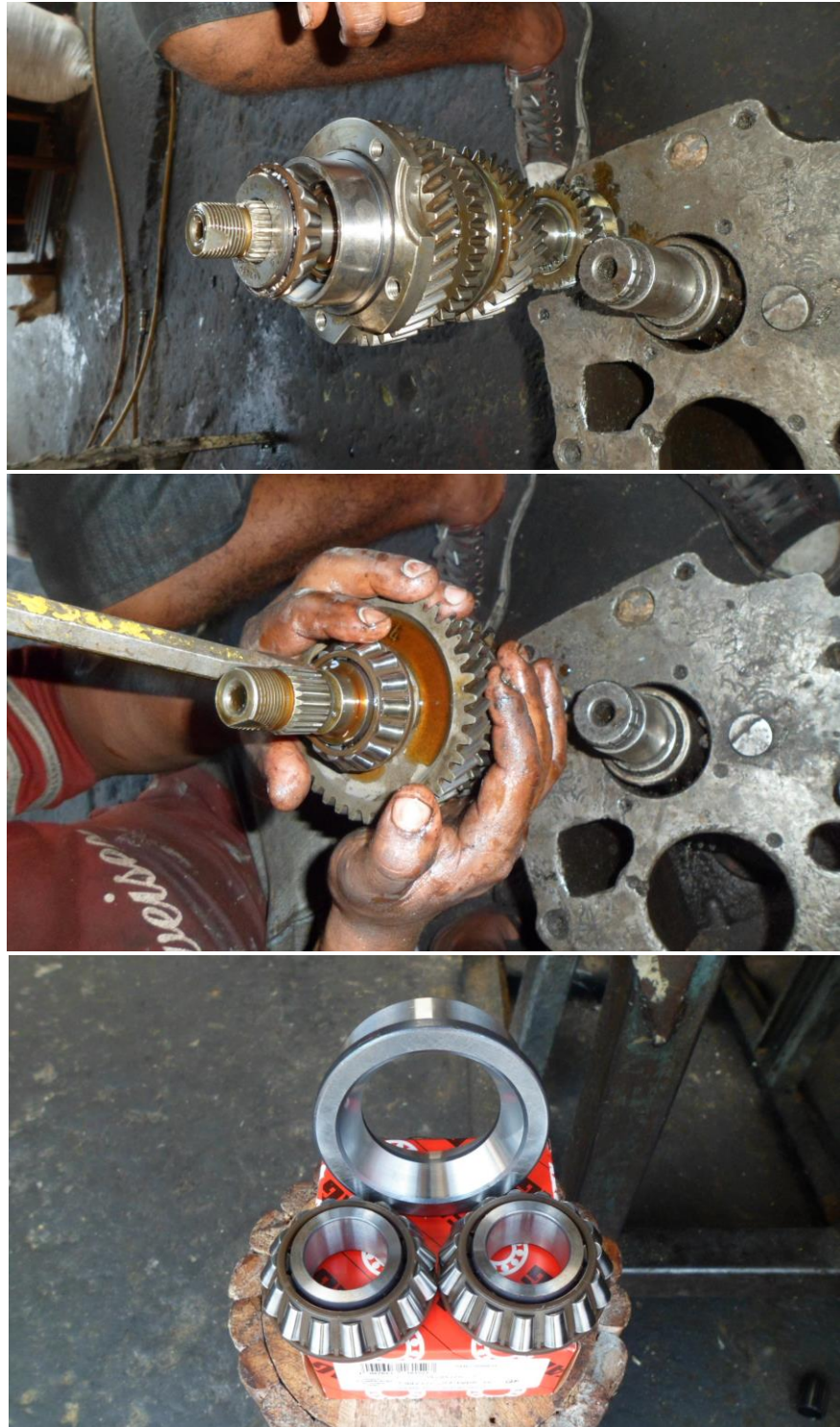
FIGURA 3.43 RODAMIENTOS POSTERIORES, INTERNO Y EXTERNO, PISTA EXTERNA (ÁRBOL DEL PIÑÓN)
