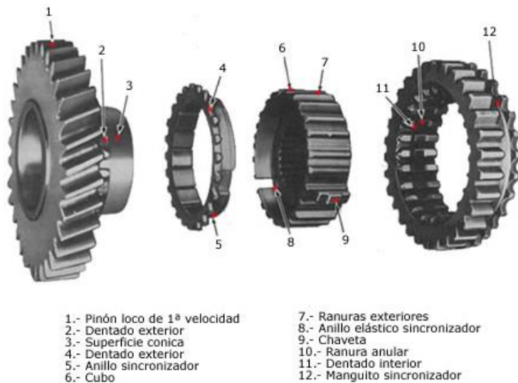
FIGURA 2.2 DESPIECE PARCIAL DE UN SINCRONIZADOR
