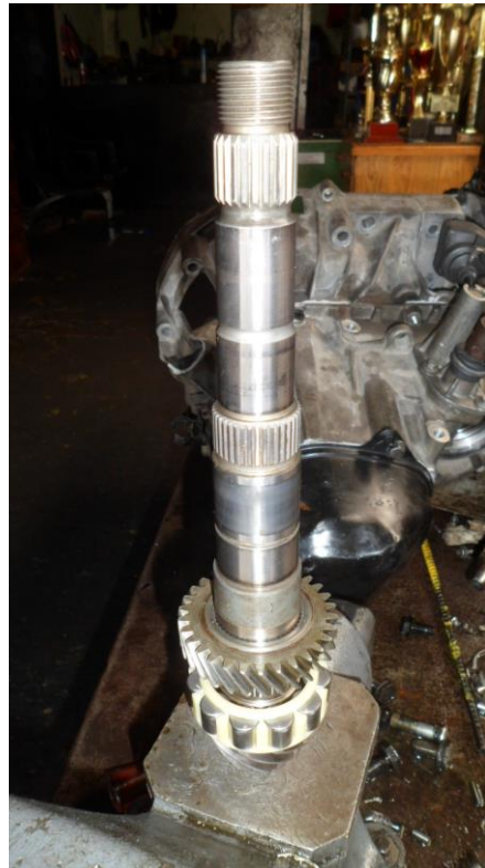
FIGURA 3.41 ÁRBOL DEL PIÑÓN (EJE SECUNDARIO)
