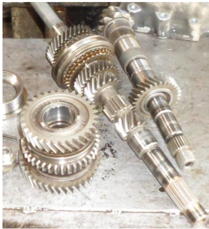
FIGURA 3.36 VERIFICACIÓN DE PIÑONES
