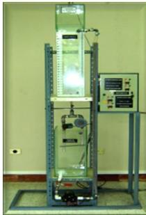
Figura 17: Planta Control de Nivel
