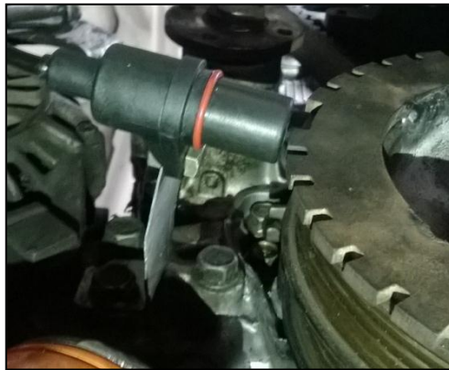
Figura 3.20 Instalación de CKP.
