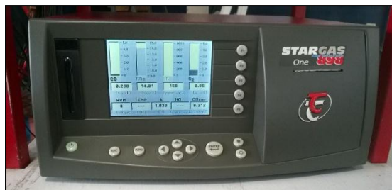
Figura 3.1 Analizador de gases Stargas 898 Plus Fuente: Autor – José Gabriel Murillo
