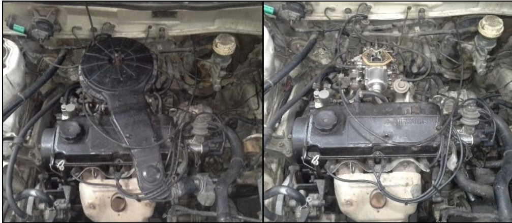
Figura 3.5 Desmontaje de depurador antes y después Fuente: Autor – José Gabriel Murillo
