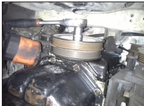
Figura 3.6 Desmontaje de polea de cigüeñal Fuente: Autor – José Gabriel Murillo
