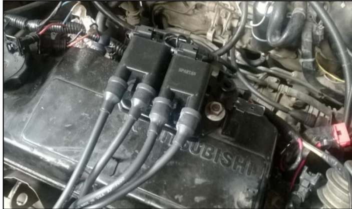
F Figura 3.21 Instalación de bobinas. Fuente: Autor: - José Murillo
