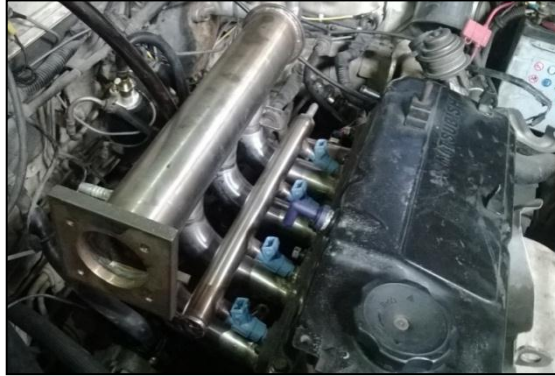
Figura 3.19 Instalación de flauta e inyectores.
