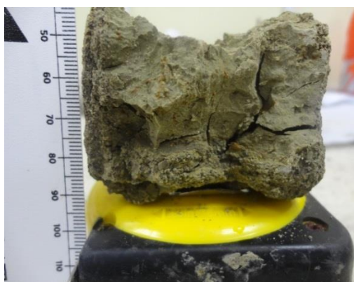
Figura 4.37. Arcilla con intercapas de arena y patinas de oxidación.
