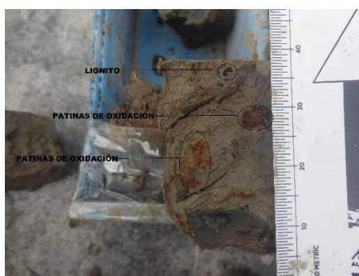
Figura 4.49. Limo con patinas de oxidación y algo de lignito.
