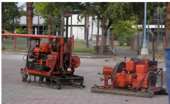
Figura 3.2. Sonda ACKER TP 30 sobre patines.
