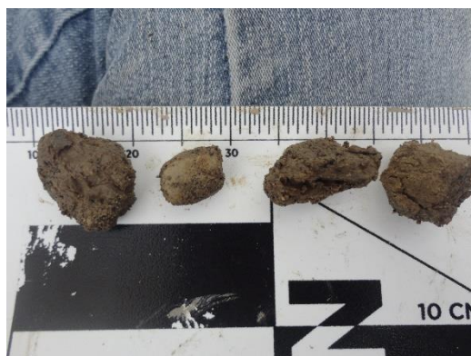
Figura 4.54. Nódulos de arcilla en la arena.
