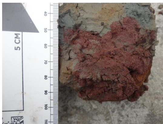
Figura 4.61. Limo con oxidación presente.
