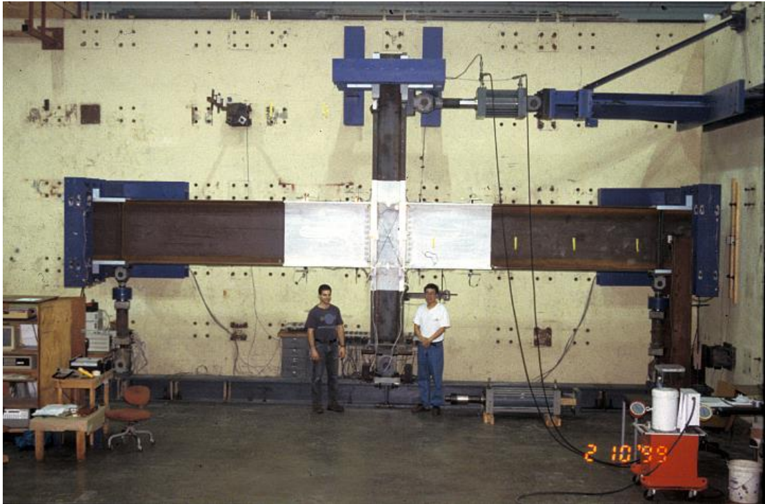
Figura 5.7. Fotografía de un espécimen de un ensayo de cruciforme real (Engelhardt, 2007a)
