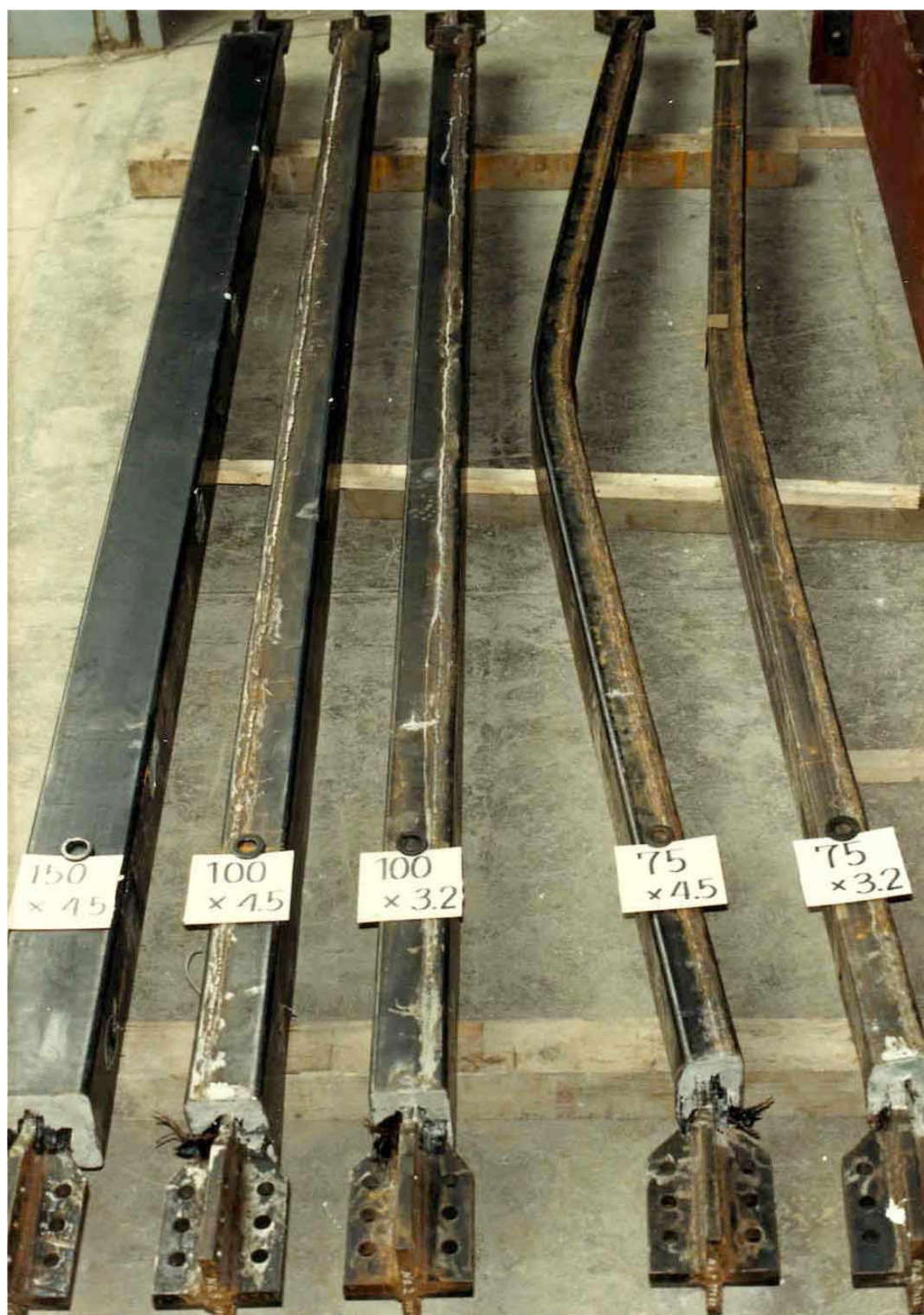
Figura 2.25. Estado post-ensayo de los APR desarrollados por Watanabe et al. (1988)
