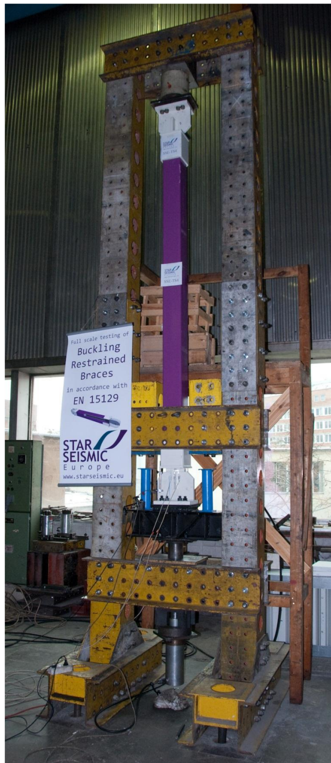
Figura 5.11. Fotografía de un espécimen de un ensayo de APR Star Seismic individual real (Dunai, et al., 2011)
