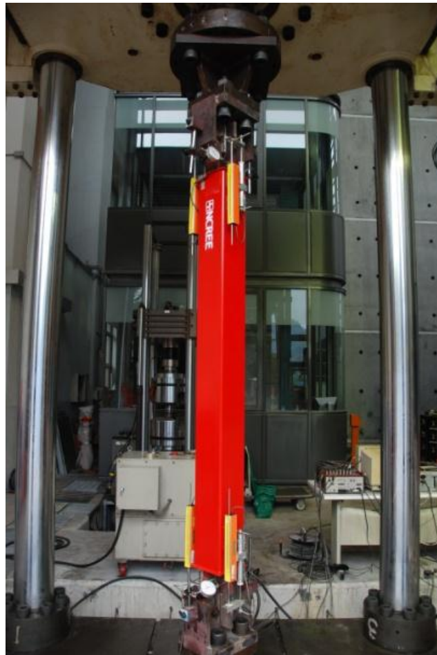
Figura 5.10. Fotografía de un espécimen de un ensayo de APR individual real (Tsai, et al., 2014)
