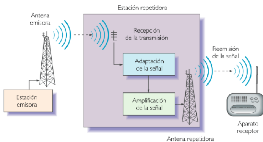
Figura 1. 1: Esquema de Sistema de Radiodifusión. http://produccionradio10.blogspot.com/
