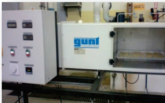
FIGURA 2.5. EQUIPO UTILIZADO EN LA PRUEBA PILOTO DE DESHIDRATADO DE ZAPALLO.
