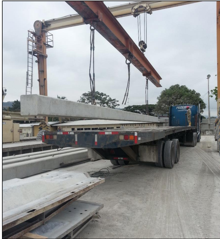
Figura 5.16. Plataforma de traslado de pilotes.
