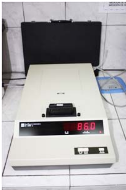
FIGURA 3.3 MEDIDOR DE BLANCURA KETT C-300
