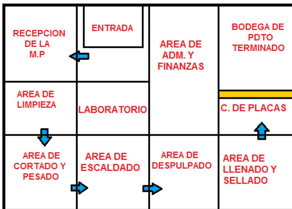
Plano 1. Diseño del lay out de la planta propuesta
