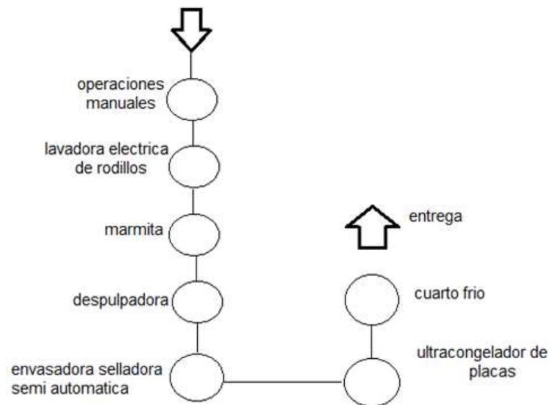
**FIGURA 1.2. Diagrama de equipos general para el proceso de elaboración de pulpas de frutas**
