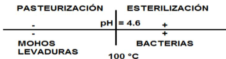
**Figura 3.1: Rango de ph para procesos de pasteurización y esterilización
