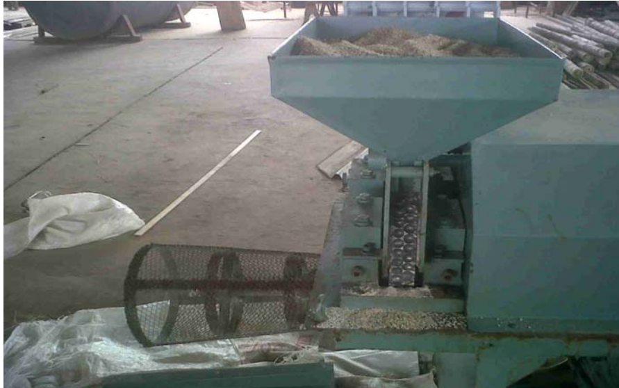
FOTO E2: BRIQUETADORA
