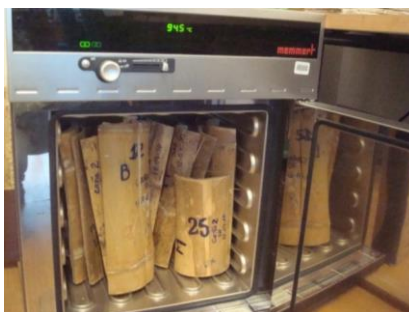
GRÁFICO 4.7. Secado con horno
