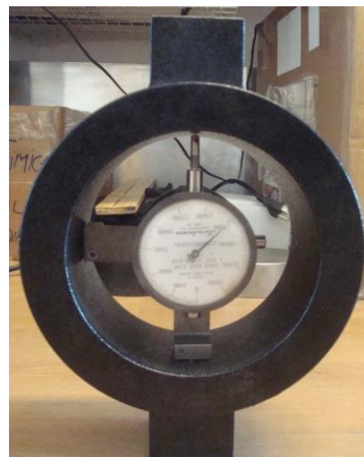
GRÁFICO 4.21. Anillo de calibración
