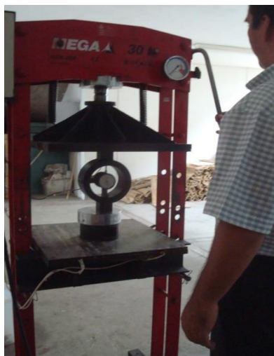
GRÁFICO 4.20. Calibración de prensa hidráulica Marca Mega 30 Ton
