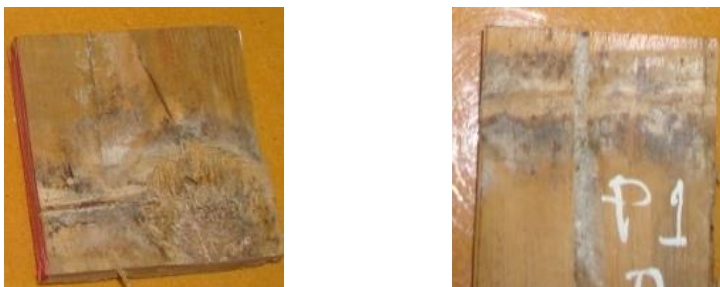
GRÁFICO 4.17. Fallas en función de la existencia del nudo
