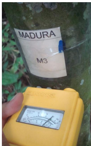
GRÁFICO 2.11. Medición de CH – Método eléctrico [11]
