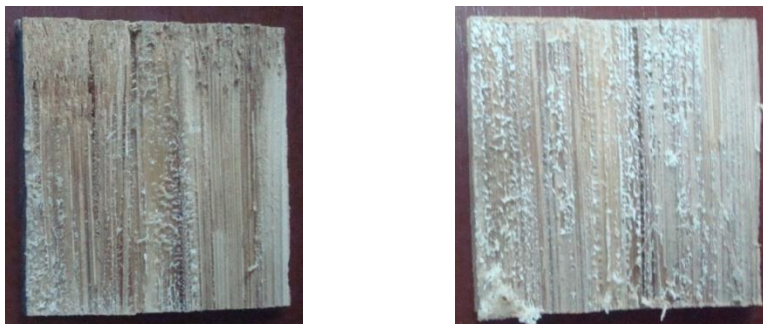
GRÁFICO 4.16. Fallas en función y aplicación del pegante
