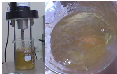
FIGURA 4.8: VISCOSIMETRO ROTACIONAL CON LA MUESTRA DE PECTINA EN LA BASE DE JARABE GELIFICADO.
