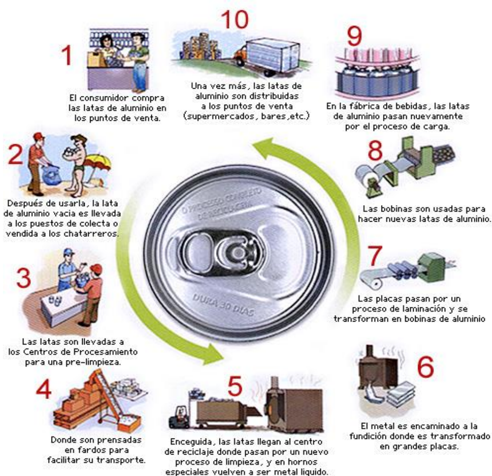
FIGURA 13: Esquema de proceso de reciclado de latas de aluminio
