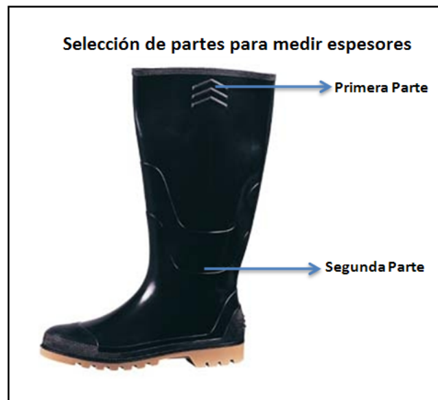
Figura 3.5: Selección de partes para medir espesores.
