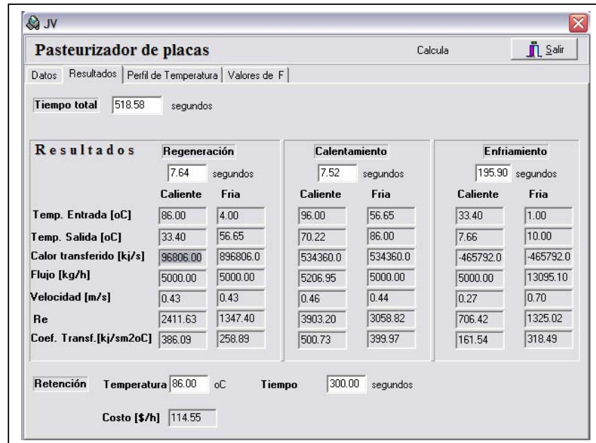
Fig. 4.19 Costo/ hora ($114,55) para el proceso de 300 segundos a 86°C, factor de incrustación de 0,011 \text{sm}^2\text{oC}/\text{KJ} Maldonado [2007]
