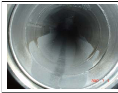
Fig. 4.1. Foto de la entrada del tubo de retención al final del proceso a 90°C, se observa una capa blanquecina. Maldonado [2007]
