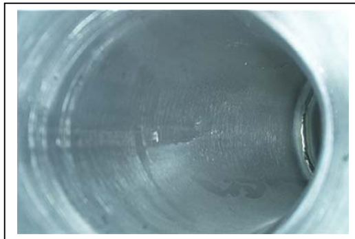
Fig. 3.11. Superficie de sección de tubo de retención limpia luego de 23 ciclos de limpieza en una etapa Maldonado [2006]
