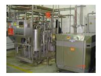
FIGURA 3.3 PASTEURIZACIÓN Y HOMOGENIZADO
