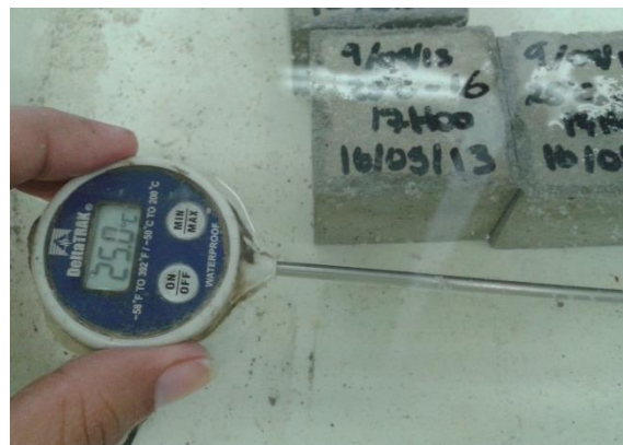
Grafica 3.17: Cubos de Mortero curados a 25°C
