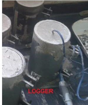
Grafica 3.21: Especímenes de Hormigón con termocoupla
