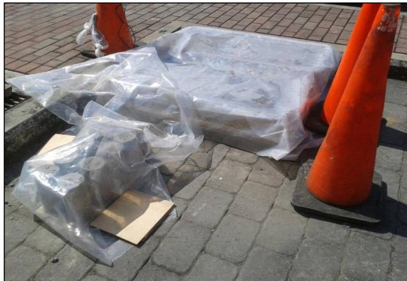
Gráfica 5.16: Cilindros y Pavimento en mantenidos Obra
