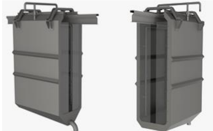
Figura 2.4. Vista general de la lavadora de carcasas
