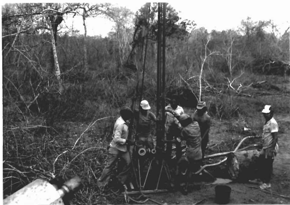
FOTO 2. Vegetación caracterizada por la presencia de arbustos. Mostrandose además, perforaciones realizadas a 60 pies de profundidad para sísmica de reflexión.
